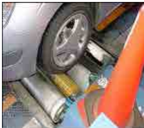
ブレーキテスタにより 制動力を確認
