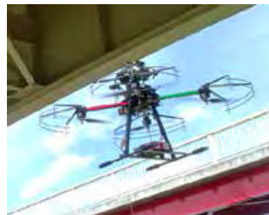
橋梁の損傷写真を 撮影する技術
