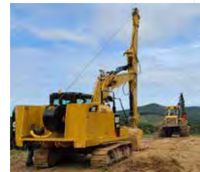
250mのウインチを装備し、牽引力は最大8トン
