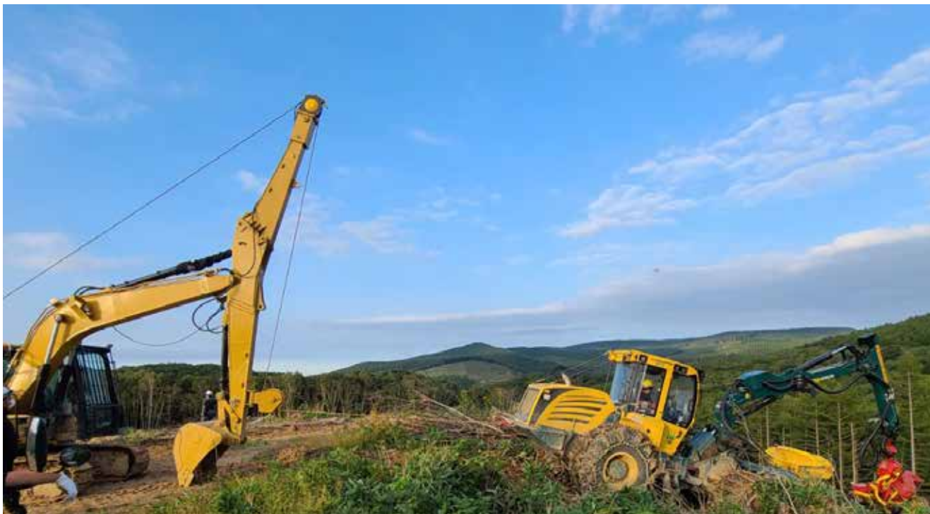
左が開発した「テザー」。傾斜地で伐採用重機の走行をアシストする。
