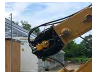
ワイヤ張力調節装置（イジェクター）で、ワイヤーの「乱巻き」を防止
