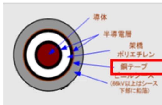
通常の高圧ケーブルの例
