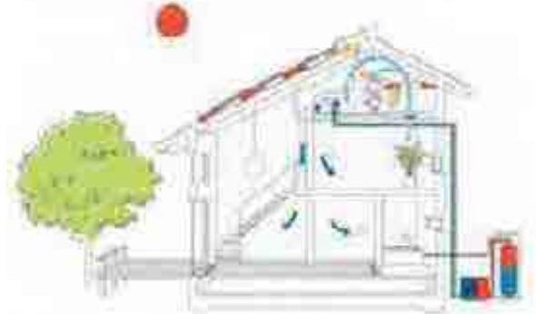
ヒートポンプ冷房と排熱利用給湯
