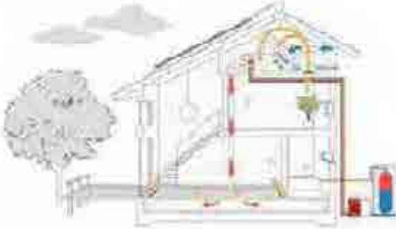
ヒートポンプを利用した暖房
