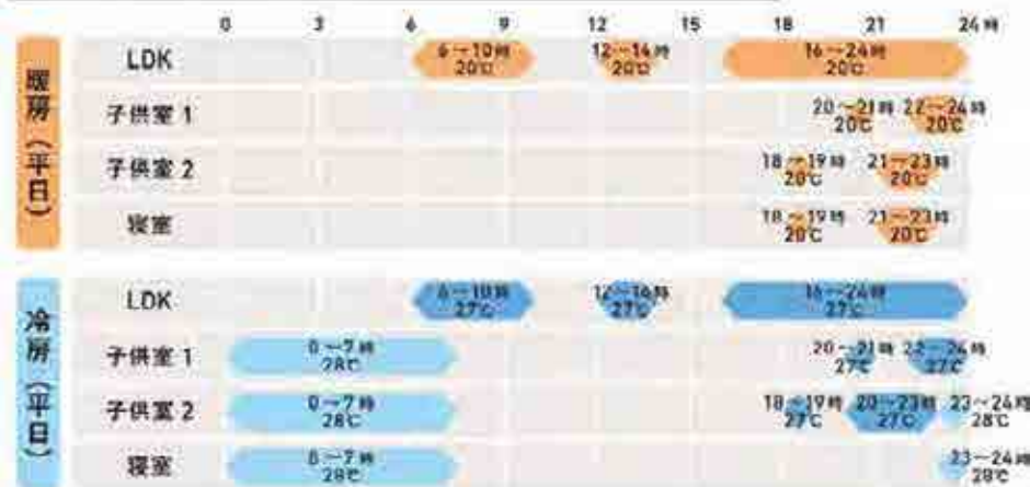
「居室間欠」の空調設備を選択した場合に想定されている暖冷房スケジュール
