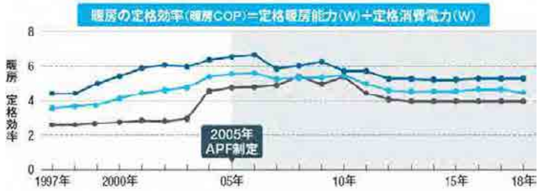
通年エネルギー消費効率 (APF) = 年間暖房熱負荷 (kWh) ÷ 年間消費電力量 (kWh)
