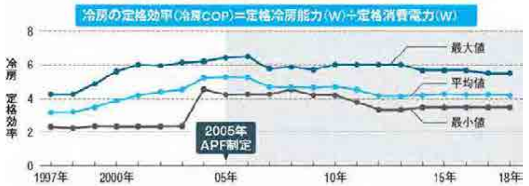
(図3) エアコンの定格効率は低下傾向、APFも頭打ちに
